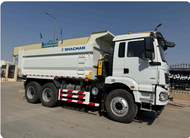
قلابات الترحيل، نقل ناتج الحفر للمرامد
