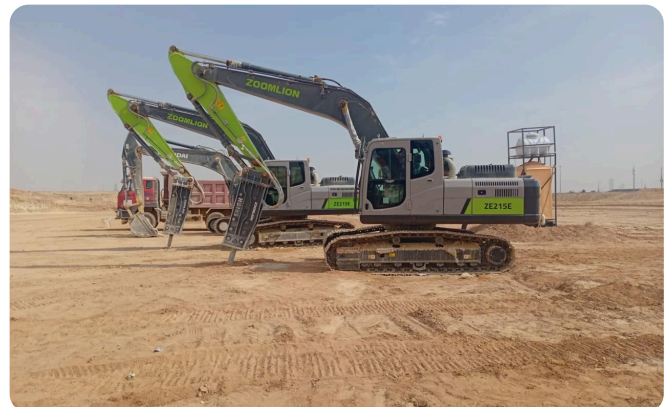
حفارة مجهزة بكسارة هيدروليكية للقطع الصخري
